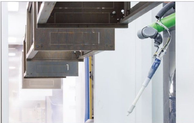
Spritzautomat in der Pulverlackiererei
